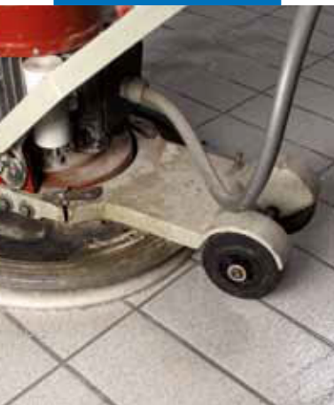
Čistenie povrchu vodou a s použitím výkonných rotačných diskových hladidiel s čistiacimi nástavcami Scotch-Brite®
